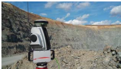
Рисунок 2 – Оперативный способ контроля состояния прибортовых массивов на карьерах
