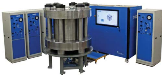
Рис. 5. Одна из последних разработок - автоматизированная система GCTS RPS-600 для испытаний горных пород в условиях независимого трехосного сжатия, включая гидроразрыв, (образец 300,0 мм x 300,0 мм x 300,0 мм) с использованием ультразвука и акустической эмиссии, с температурами до +200°C, давления до 100 МПа
