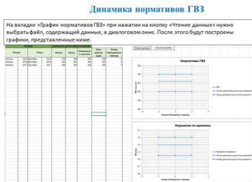
Рисунок 3 – Стартовое (а) и итоговое (б) окна программы решения комплекса задач нормирования готовых к выемке запасов
