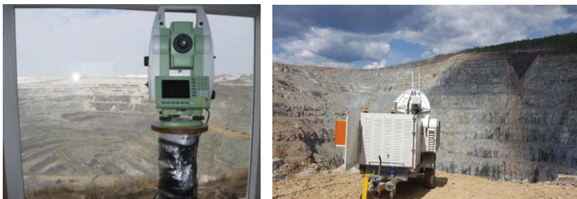
Рисунок 4 – Система автоматизированного контроля GeoMoS и радар MSR3000 на карьере «Васильковский»
