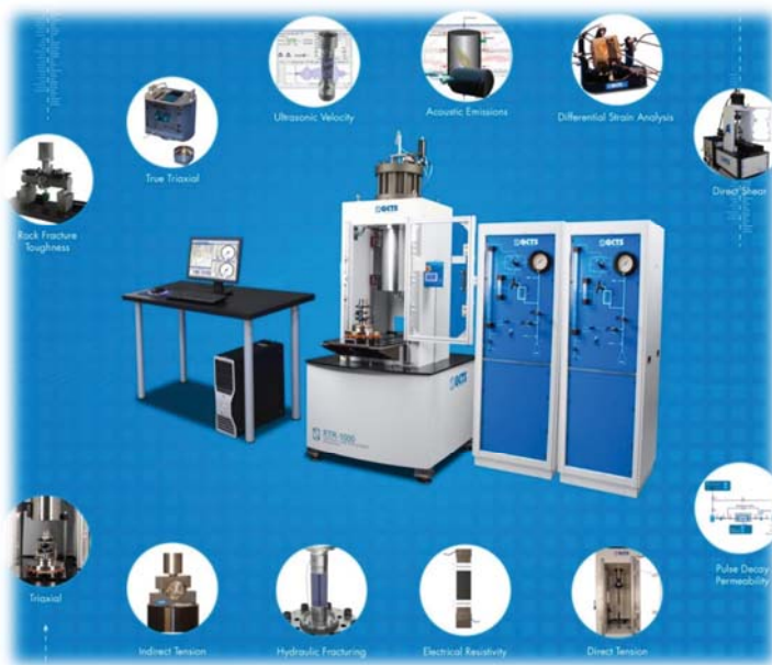
Рис. 2. Основные возможные типы испытаний для систем серии RTR
