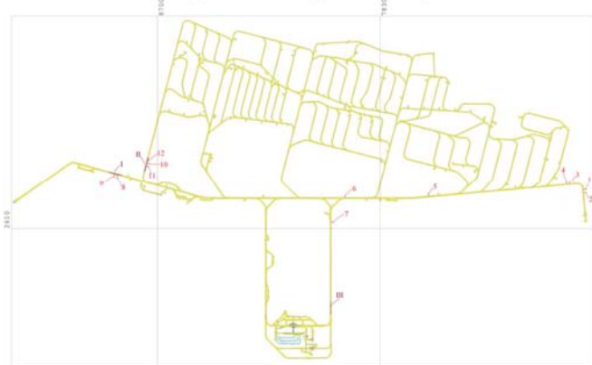
Рисунок 3 – Расположение пунктов измерений на гор. -260 м (1-11 - Вертикальные щели; 12 - Горизонтальная щель; I-III - профили электрометрии)
