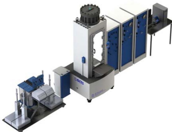
Рис. 3. Лаборатория для испытаний на проницаемость и ГРП на базе RTR
