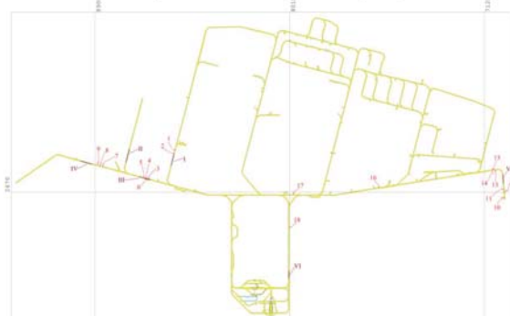
Рисунок 2 – Расположение пунктов измерений на гор. -330 м (1-5, 7-14, 16-18 – вертикальные щели; 6,15 – горизонтальные щели; I-VI – профили электрометрии)
