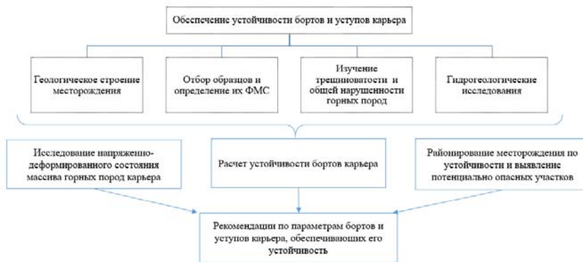
Рисунок 1 – Краткая блок-схема работ по обоснованию устойчивых параметров бортов и уступов глубоких карьеров
