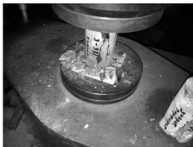
Рисунок 3- Испытание образцов на сжатие
