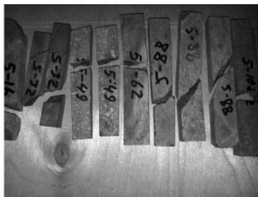
Рисунок 4- Испытание образцов на растяжение
