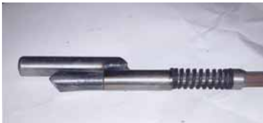
Рисунок 4— Устройство для бурения параллельно-сопряженных шпуров (Предпатент РК №3805)
